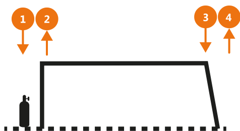
Рисунок 42. Логика 4Т кнопки сварочной горелки
